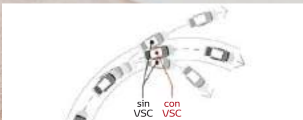
Control de estabilidad (VSC), control de tracción (TRC) y asistente de arranque en pendientes (HAC).
