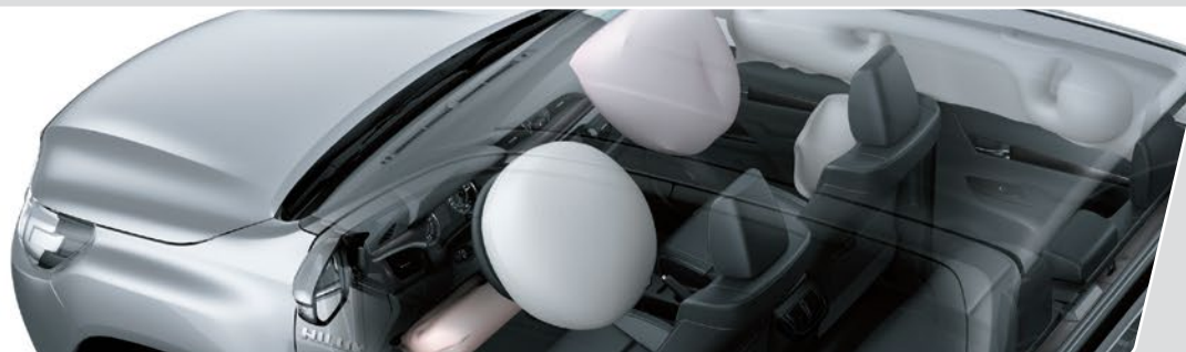
7 airbags: frontales (conductor y acompañante), de rodilla (conductor), laterales (x2) y de cortina (x2)*1
