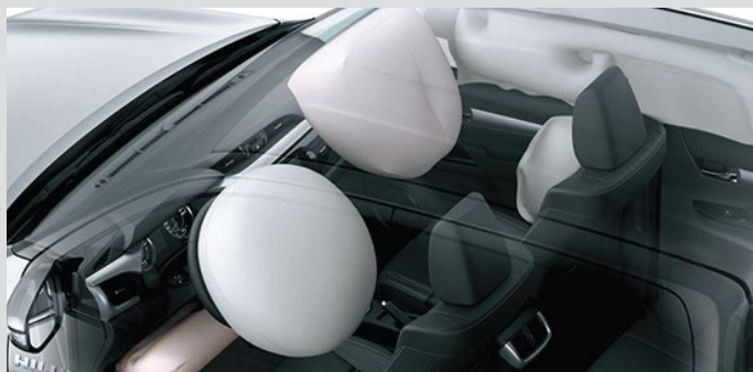
7 airbags: frontales (x2), de rodilla (conductor), laterales (x2) y de cortina (x2)
