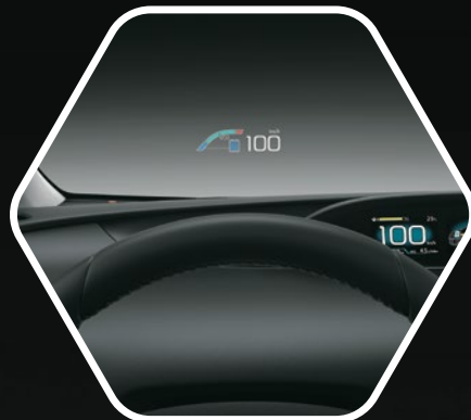
Proyección de información múltiple sobre el parabrisas "Head Up Display".
