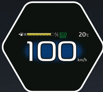
ECO MODE: Funcionamiento con ambos motores pero priorizando el consumo de combustible.
