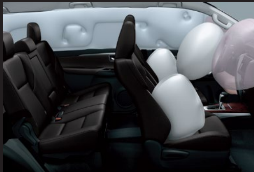
7 airbags: frontales (x2), de rodilla (conductor), laterales (x2) y de cortina (x2)
