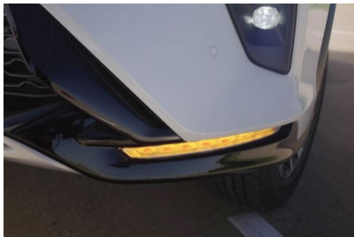
Luces intermitentes secuenciales
